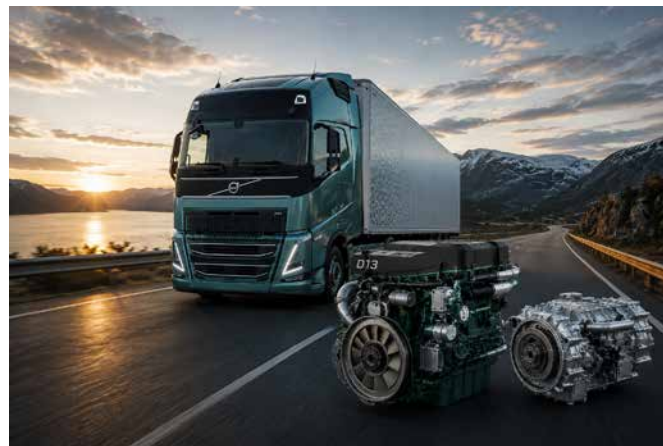
Namesto razvoja ločenih motorjev za posamezne energente je Volvo razvil skupno osnovo, ki omogoča uporabo dizelskega goriva, HVO biodizla, utekočinjenega zemeljskega plina (LNG), bioplina ter potencialno tudi vodika.
