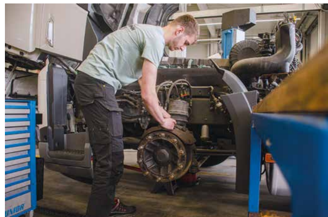
Menjava zavornih ploščic na Volvovem tovornjaku.
