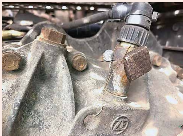
Magnet na pulzatorju, ki kazi realno sliko prikaza delovnega časa.
