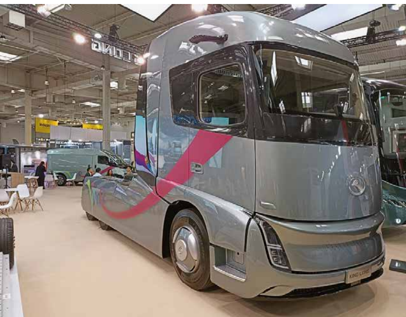
King Long vlačilec Merry Haul, opremljen z motorjem na vodikove gorivne celice z močjo 180 kW/220 kW.
