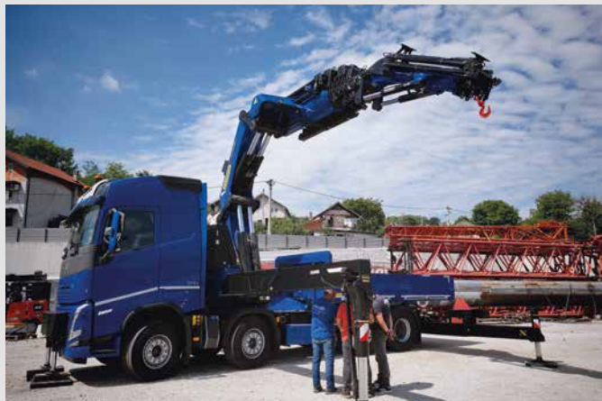
Glede na število izvlečenih segmentov lahko žerjav Palfinger dvigne tovor do 22 ton.
