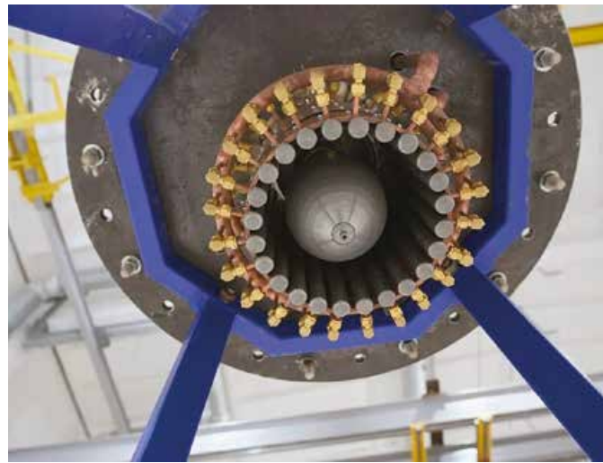
Prototip se preizkuša v 14 metrov dolgi vakuumski komori, zasnovani za simulacijo vesoljskih razmer.
