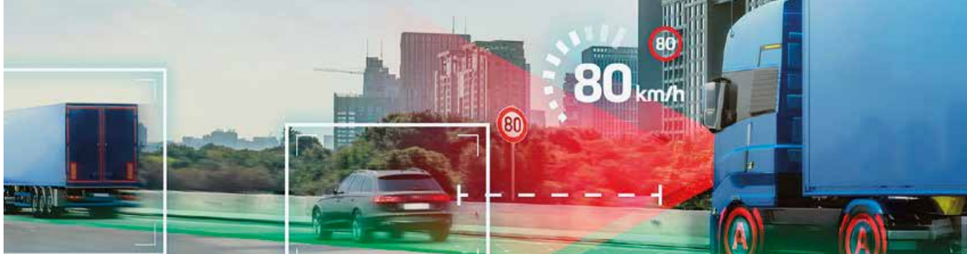
Prepoznavanje znakov ali vzdrževanje varnostne razdalje sproži samodejno zaviranje.
