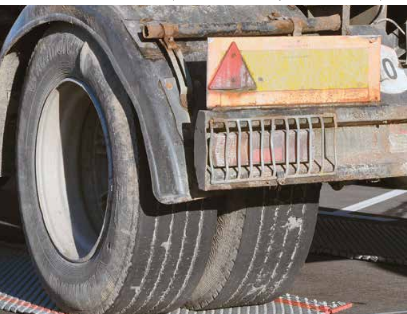
Preverite globino profila pnevmatik, tlak in morebitne poškodbe ali zatakne predmete.
