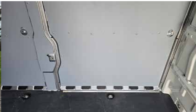
L3 H2 izvedba ponuja 15 m 3 tovornega prostora, v katerem je nedrseča podlaga in pritrditvena ušesa na tleh in v steni.
