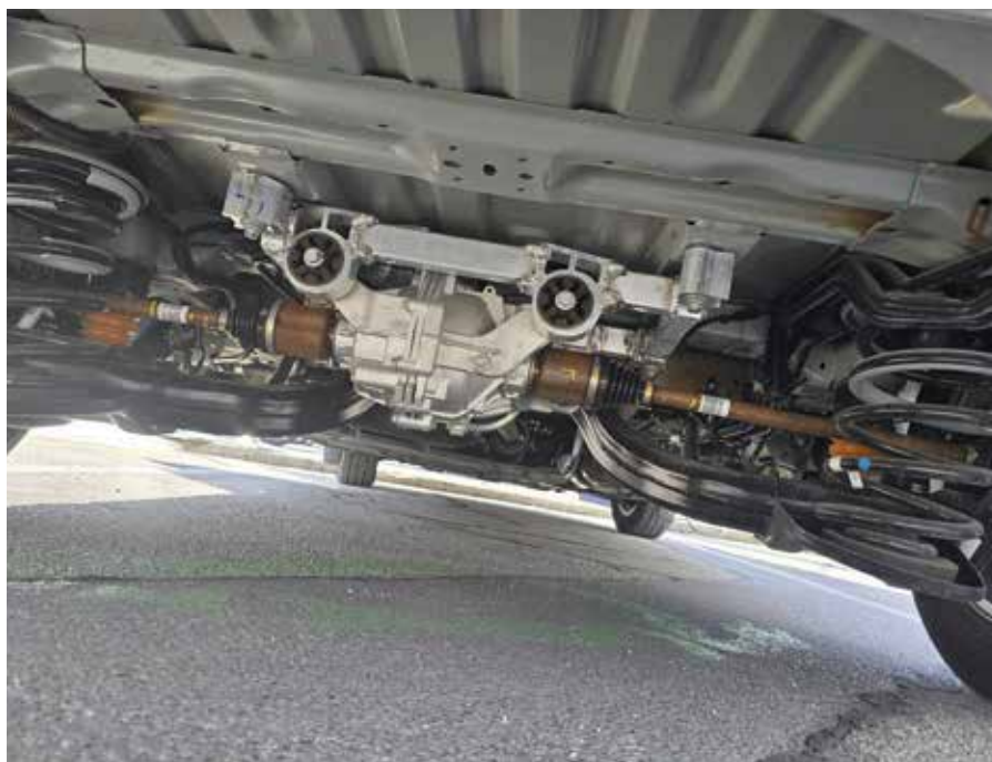
Štirikolesni pogon 4Motion z elektronsko krmiljeno lamelno sklopko na zadnji premi prenos moči samodejno prilagaja posameznim voznim situacijam. Nizka masa sistema je osnova za optimalne vozne lastnosti, visoko vozno dinamiko in dobro gospodarnost.
