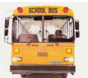
TAM 232 A 121 – šolski avtobus za ameriški trg je imel na šasiji TAM nameščen motor Cummins, medtem ko je bil na Avtomontažini karoseriji opazen sprednji del, povzet po MAN mestnih avtobusih. Več prototipov šolskih avtobusov je bilo po testiranju v Kaliforniji pozitivno ocenjenih.
