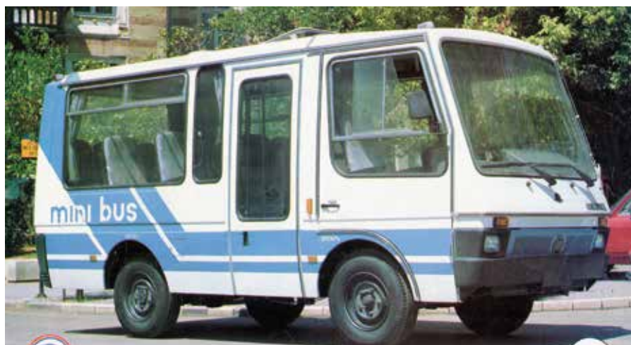
Poceni minibus TAZ A21 je nastal v sodelovanju s Hercegovina Auto in uporabljal šasijo tovornjaka češke Avie, v načrtu pa je bila tudi reševalna različica.
