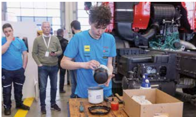
Menjava vložka sušilca zraka na Volvovem tovornjaku.
