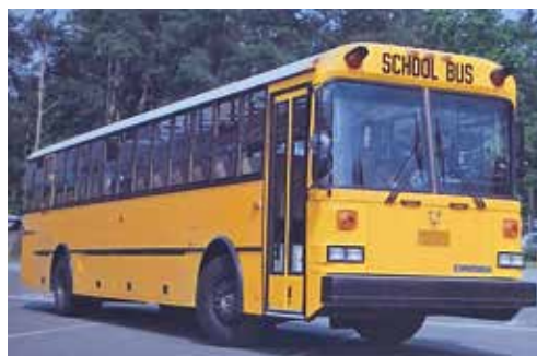
TAM 232 A 121 – šolski avtobus za ameriški trg je imel na šasiji TAM nameščen motor Cummins, medtem ko je bil na Avtomontažini karoseriji opazen sprednji del, povzet po MAN mestnih avtobusih. Več prototipov šolskih avtobusov je bilo po testiranju v Kaliforniji pozitivno ocenjenih.
