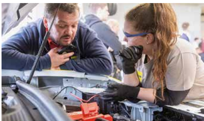
Preverjanje napetosti na 12-V bateriji.
