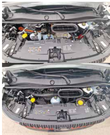
V obeh primerih je spredaj nameščen motor, le da je pri električno gnanem Mastru v tem predelu veliko več prostora.
