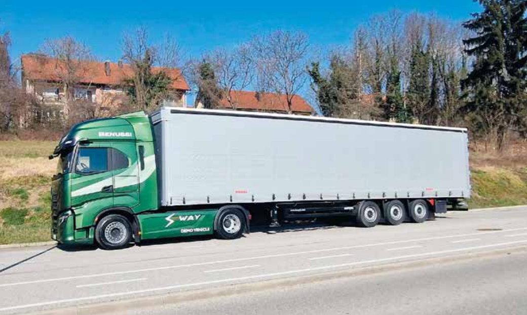
Naš testni Iveco S-Way je poganjal šestvaljni 12,9-litrski motor xCursor 13 s 500 KM in visokim navorom do 2.600 Nm.
