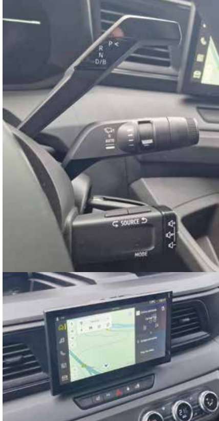
Ročica samodejnega menjalnika je postavljena desno izza volanskega obroča, kjer je tudi stikalo za upravljanje z radijskim sprejemnikom. Slednjega lahko krmiliti tudi preko osrednjega zaslona na dotik.
