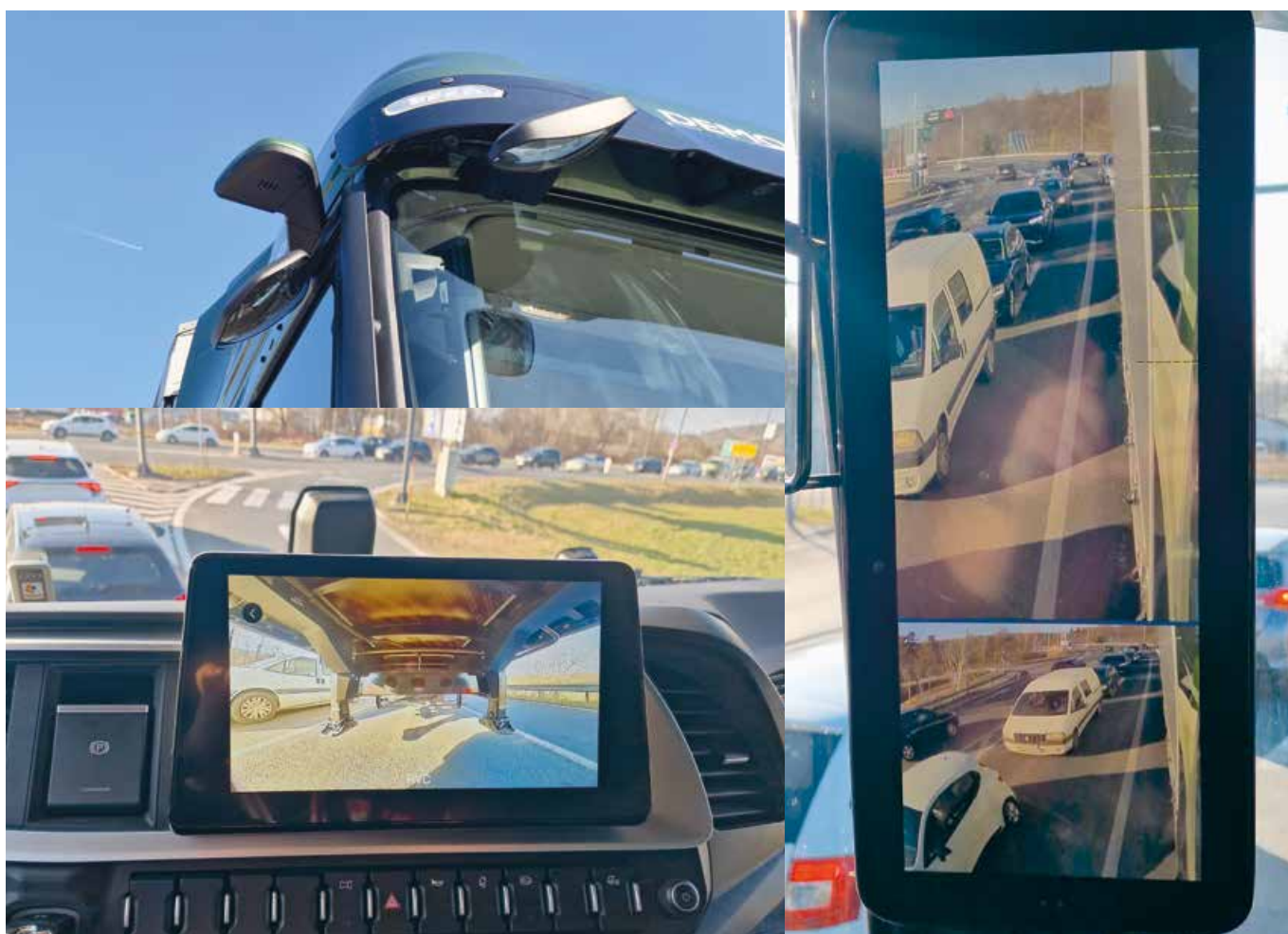
Z uvedbo MirrorCam Iveco S-Way postavlja nove standarde v varnosti, udobju in učinkovitosti za voznike tovornih vozil. Prikaz je sedaj veliko boljši tudi v temi in dežju. Dodatne črte omogočajo jasno nastavitev globine, dodana pa je tudi kamera na zadku za lažje pripenjanje prikolice.
