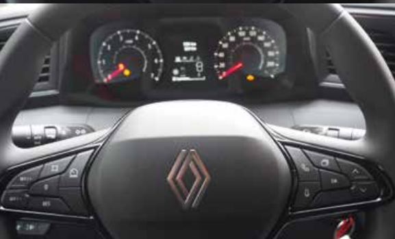
Električna izvedba je bolj digitalizirana. Ne v električnem ne v dizelskem Mastru ni električne parkirne zavore in v obeh primerih je za zagon potrebno vstaviti ključ in ga obrniti.
