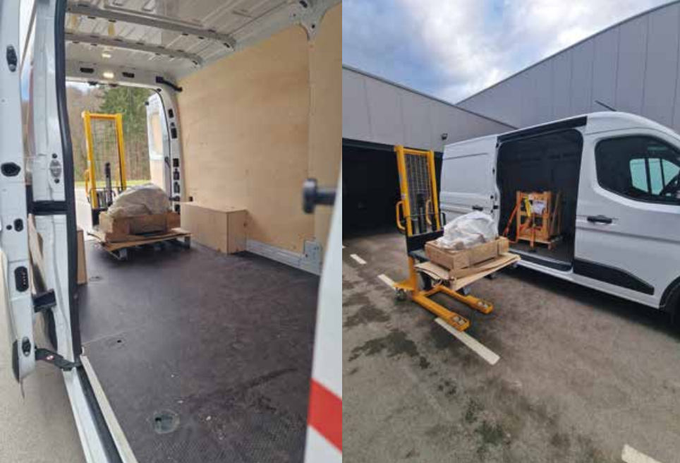
Široka dvokrilna vrata zadaj se odpirajo do 270 stopinj in omogočajo enostavno nalaganje tovora z viličarjem. Bočna drsna vrata so sedaj za 4 cm širša, tako da je možno skozi njo nalagati evropaleta v obeh smereh.
