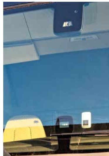
Za vetrobranskim steklom so kamere, ki spremljajo potek črt na cesti.
