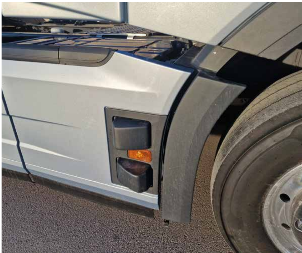
Radarji na boku opozarjajo voznika na objekte v mrtvem kotu.
