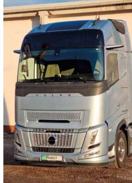
Sprednji del, ki je naprej razširjen za 24 cm, omogoča rahlo klinasto obliko in velikodušno zaobljene vogale. Logotip je premaknjen v rezo hladilnika. Od spodnjega roba vetrobranskega stekla navzgor pa je Aero popolnoma enak staremu FH.
