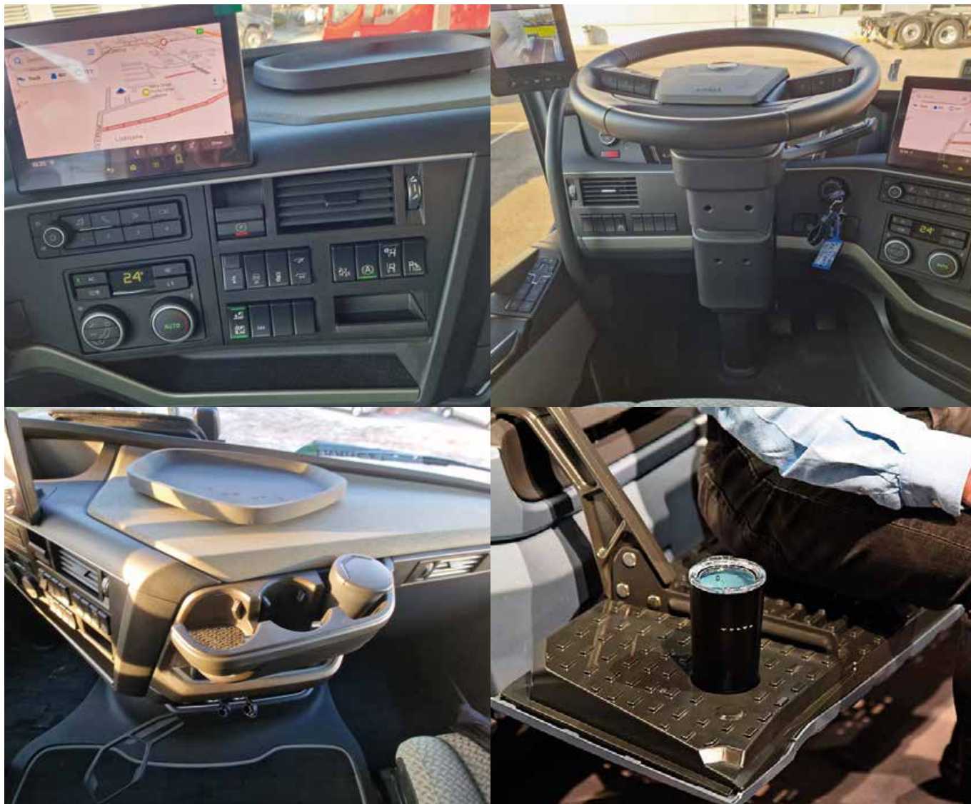
Notranjost je res šolski primer ureditve. Volan se preklopi visoko in omogoča lahkotno premikanje po kabini. Večina tipk je še vedno klasičnih in zahtevajo pritisk. Na sredini so tri odprtine za pijačo in držalo za plastenko, tu pa so tudi trije USB-C priklopi. Ob lepem vremenu se lahko voznik spočije tudi na sprednji maski.
