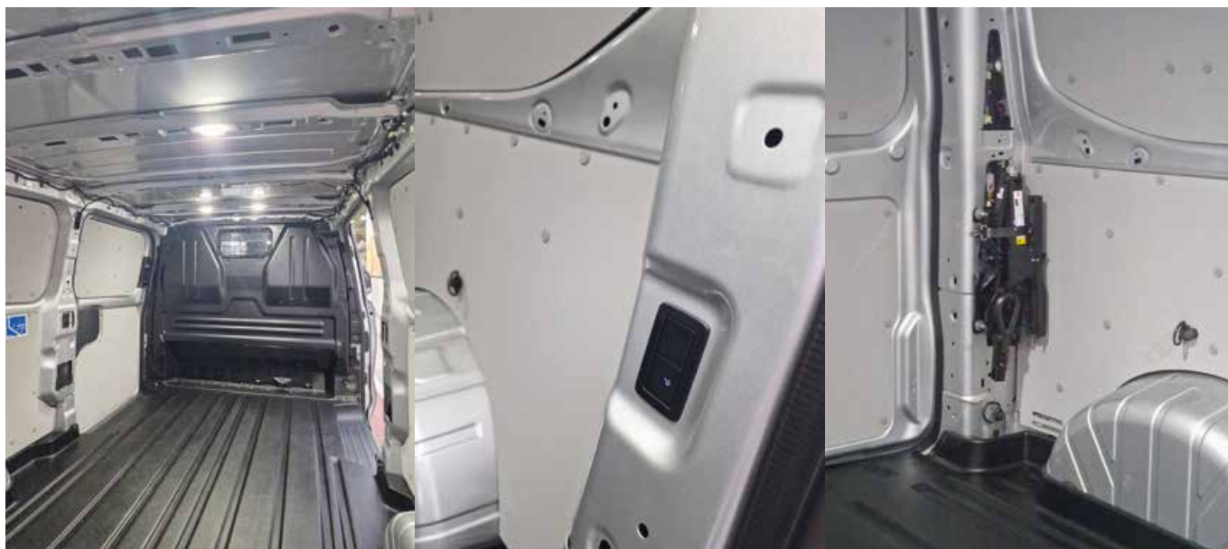
Tovorni prostor je obložen, na tleh pa je protizdrsna podlaga. Po celotni notranjosti so pritrjevalna ušesa ter LED osvetlitev, dodatna luč pa je tudi na zunanji strani, da si lahko osvetlite okolico vozila.
