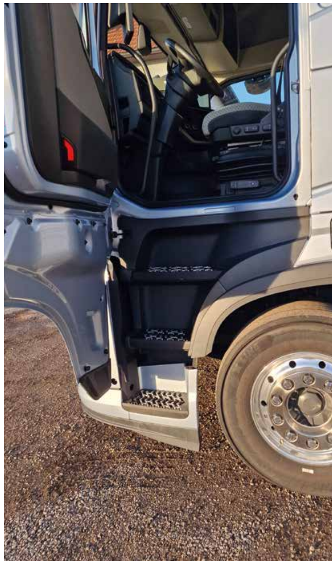
V kabino se vstopa preko treh stopnic, X-Line energy pnevmatike pa poskrbijo za nizek kotalni upor, nizko raven hrupa in nižjo porabo.
