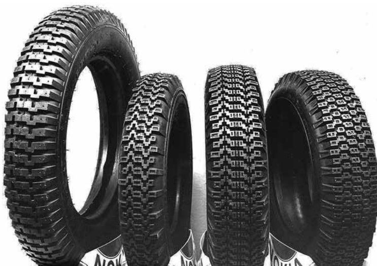
Kelirengas – za razliko od letnih pnevmatik se prečni žlebovi v tekalni plasti veliko učinkoviteje zagrizejo v zasneženo cestišče.
