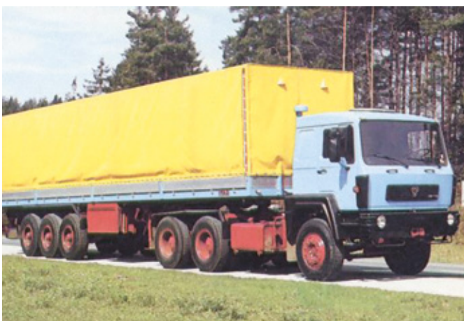
Leta 1984 se je tudi TAM končno pridružil težkemu razredu, vendar je moč 240 KM zadostila le minimalnim zahtevam, nova trambus kabina pa je bila preozka za mednarodne proge.
