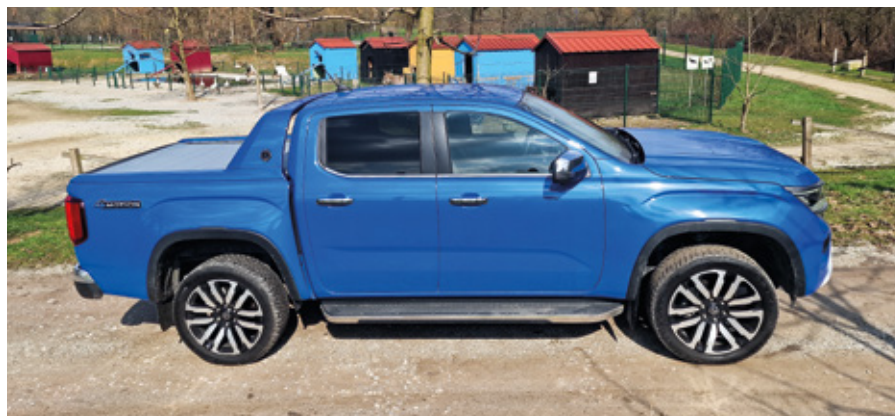
Petsedežni pickup, D x Š x V 5.350 x 1.910 x 1.884 mm, medosna razdalja 3.270 mm.
