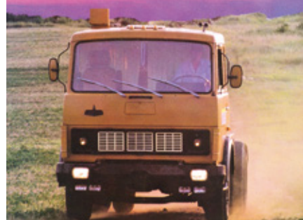
Beograjski Progres je iz ZSSR uvažal tovornjake MAZ, ki so v osemdesetih letih s turbo motorjem in 8-stopenjskim menjalnikom ponujali do 280 KM. Konservativni tovornjaki iz beloruskega Minska so v Jugoslavijo prišli v skromnih količinah.
