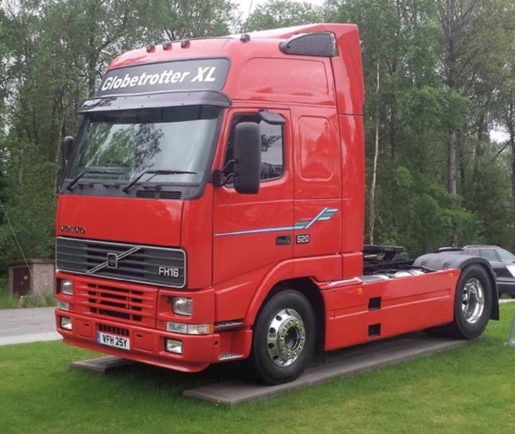
Leta 1993 je Volvo predstavil povsem novo družino tovornjakov FH; po pričakovanjih je bil eden od predstavnikov tudi novi FH16. Pogonjal ga je TD163 s 520 KM in 2.500 Nm največjega navora.
