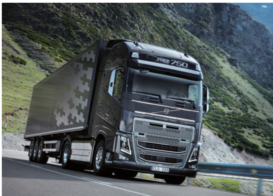
Še en pomemben mejnik v zgodovini motorja D16: leta 2011 je bil Volvo ponovno na evropskem in svetovnem prestolu – dodatno »navit« motor D16G je družini FH16 omogočil dvig moči na 750 KM in 3.550 Nm največjega navora.
