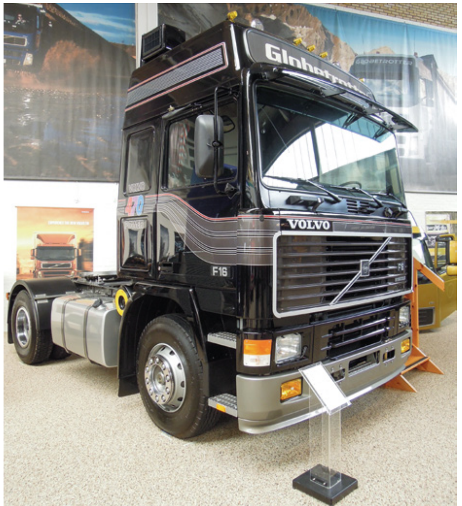
Prva »šestnajstica« se je pojavila leta 1987 in je pomenila majhno revolucijo v tovornjarski industriji: TD162 je iz 16.123 ccm »izvlekel« 465 KM. Novinec je bil nameščen v posodobljeni kabini modela F12 in je seveda dobil novo ime – F16. Proizvajalec je že takrat zagotavljal, da se motor zlahka spopade s skupno težo do 60 ton.
