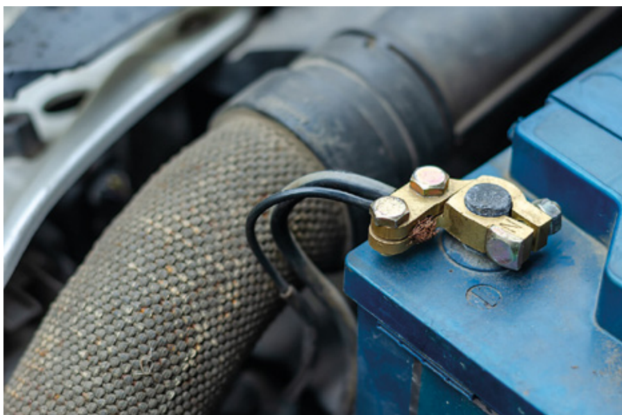
V električnih avtomobilih so še vedno nameščeni tudi klasični 12-V akumulatorji, ki opravljajo podobne naloge kot v navadnih avtomobilih.
